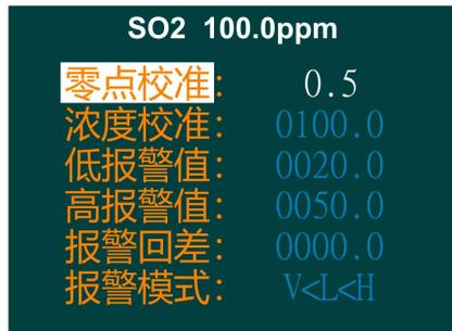
图 7.14 零点校准待确认状态
